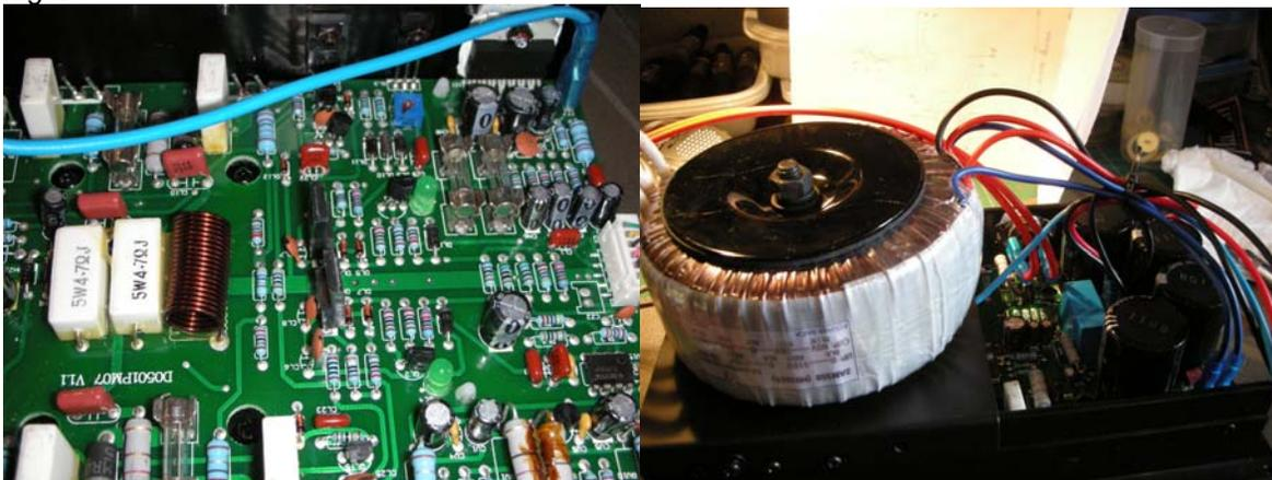
Vous pouvez constater une carte propre, capa chimique bas de gamme, connections correctes, le montage mécanique est bien réalisé,
